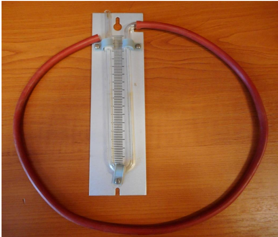
„U” alakú cső, az egyik szárára húzott gumicsővel
