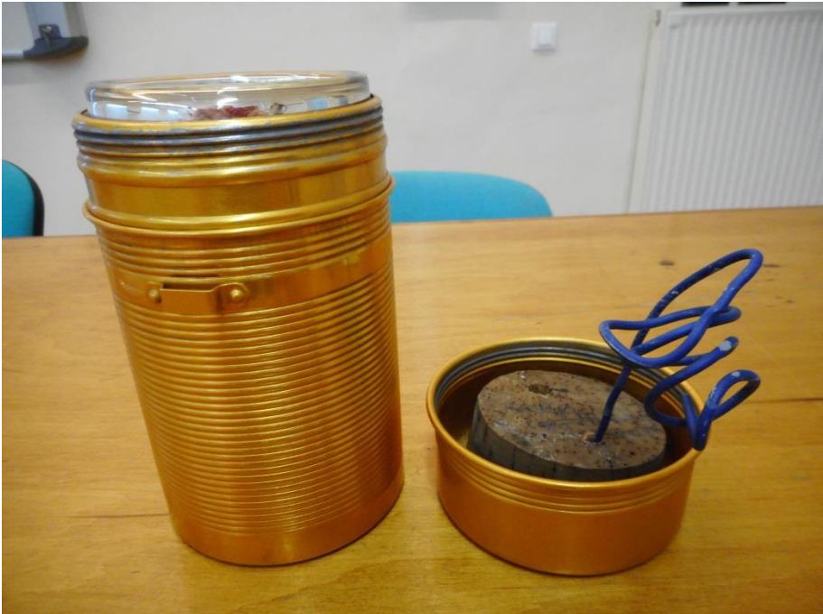
kaloriméter (hőkapacitása C = 120 \text{ J/}^\circ\text{C} )
