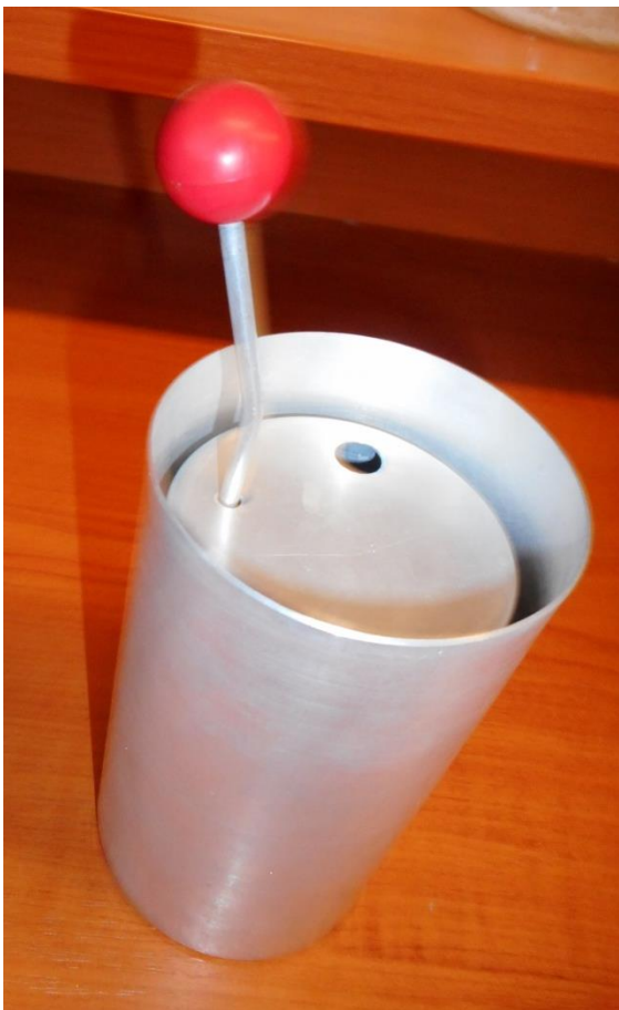
kaloriméter (hőkapacitása C = 124 \text{ J/}^\circ\text{C} )
